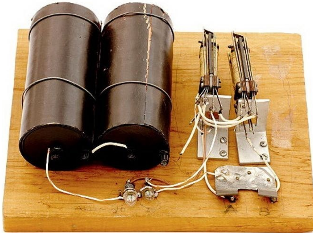
Bell Laboratories scientist George Stibitz แสดงการบวกเลขโดยใช้ รีเลย์ ตัวเครื่อง Model K
