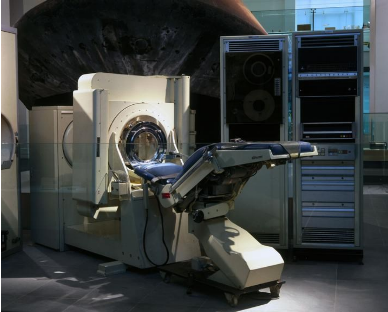
Data General Nova สำหรับประมวลผลภาพจากเครื่อง EMI Brain Scanner
