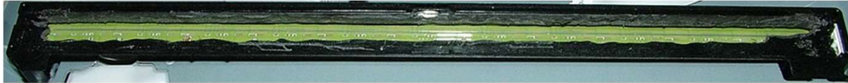
อุปกรณ์ตรวจจับภาพแบบสัมผัส หรือ ซีไอเอส (contact image sensor : CIS)
